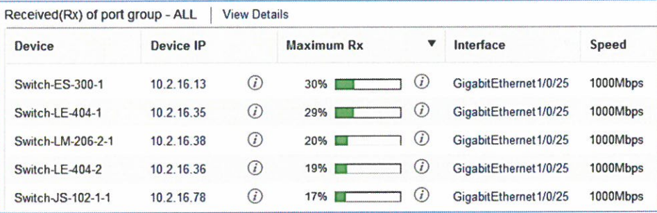
圖 12. 交換器各 PORT 接收流量使用之排行情況
