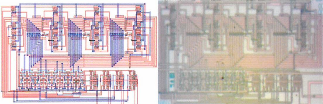
圖12. 晶片佈局圖(左)及實照圖(右)
