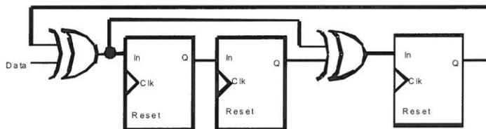
圖4. 使用LFSR之串列CRC電路 ( $X^3+X^2+1$ )
