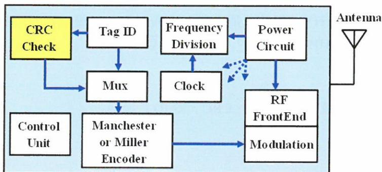
圖1.：RFID標籤(Tag)內部架構
