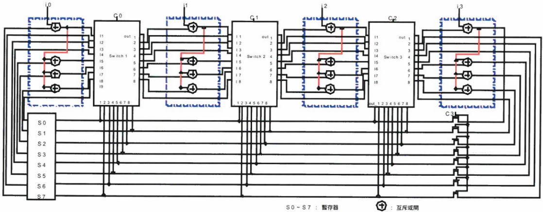
圖 9. NMOS開關切換電路
