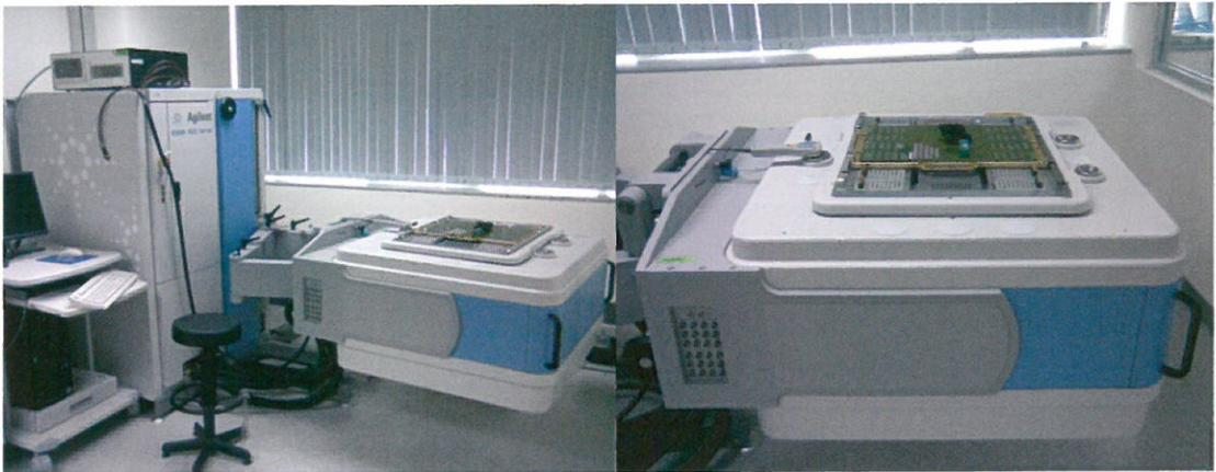
圖11. Agilent 93000測試平台
