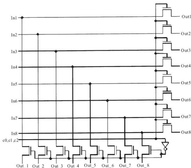
圖 8. 本文所提出之8-bit CRC電路
