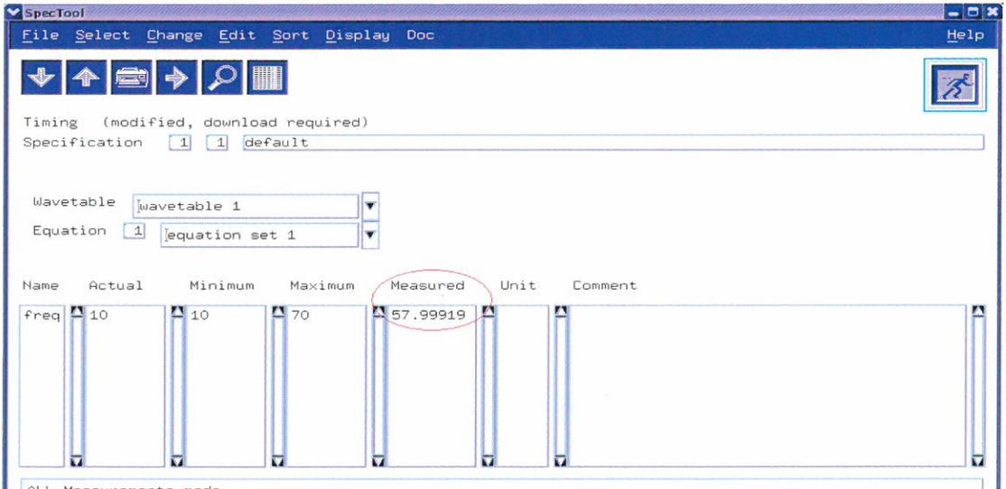
圖14. 晶片實測最大頻率
